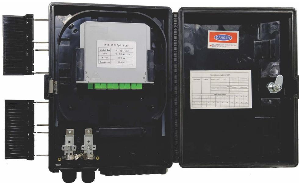
Caja de distribución óptica usada como un punto de terminación para conectar el cable de alimentación con el cable drop en una red FTTx. Permite fusión y spliteo del cable de distribución en su interior, mientras provee una protección sólida y manejo de 16 salidas para la red FTTx.
