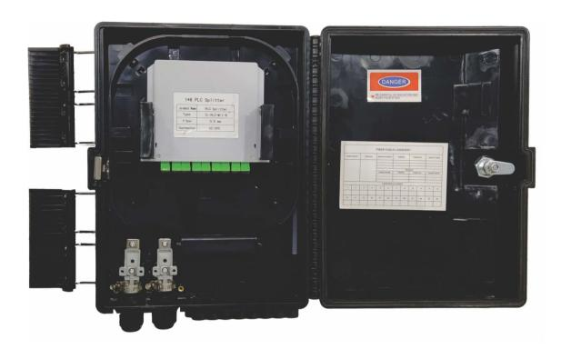
Caja de distribución óptica usada como un punto de terminación para conectar el cable de alimentación con el cable drop en una red FTTx. Permite fusión y spliteo del cable de distribución en su interior, mientras provee una protección sólida y manejo de 16 salidas para la red FTTx.
